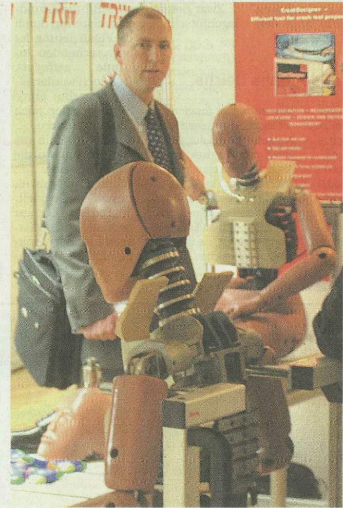
Dummys im Blick: In Crashtests werden heute ca. 25 Dummy-Arten und rund 150 Einzelprüfungen unterzogen, damit die Sicherheit bei Verkehrsunfällen weiter erhöht werden kann.
