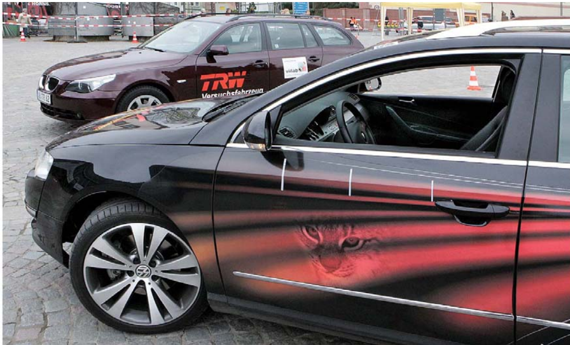
Der Lux Passat (vorne) findet seinen Weg ohne Fahrer. Drei Lasersensoren an Front und Heck erkunden das Umfeld, vier Rechner unter der Ladefläche im Kofferraum erstellen daraus ein Umgebungsbild. So kann das Fahrzeug einem Hindernis wie dem quer stehenden BMW (hinten) ausweichen. Was zur Safety Week in der Aschaffener Stadthalle so spielerisch daherkommt, hat einen ersten Sinn: Die Sensortechnik soll die Gefahr eines Zusammenpralls mit Fußgängern verringern.
